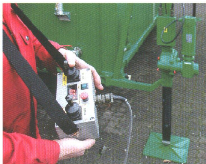
jednoduchý zvedák stavidel 100 kN s regulovaným pohonem
