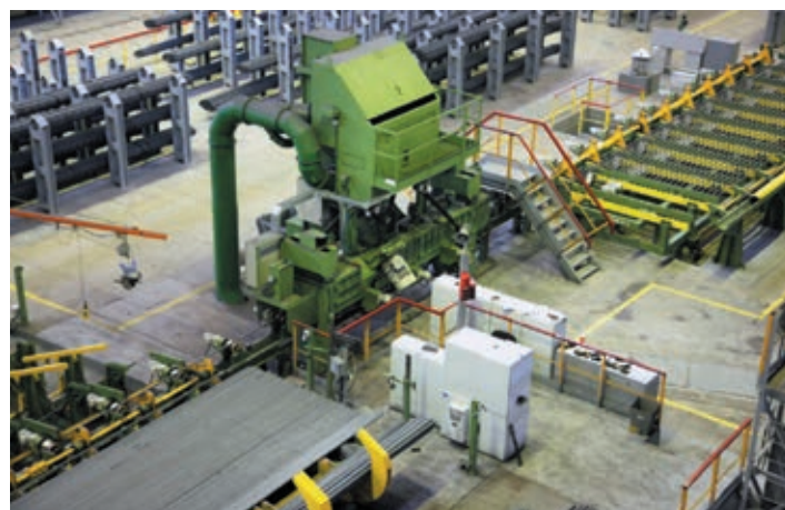
(2) tryskání tyčí ocelovými broky
