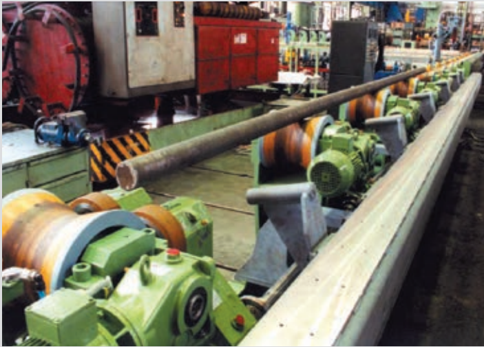
Podélný dopravník a pakování kulatiny na lince dodané firmě Sandvik, SE.
